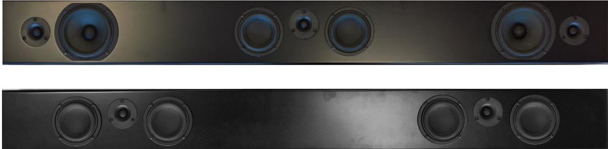
Cette image montre les haut-parleurs tels qu'ils doivent être placés, les tweeters placés entre les woofers étant justifiés vers le haut de l'armoire (voir FIG 1). Si la barre de solution est positionnée sensiblement au-dessus de la zone d'écoute, à 6 pieds ou plus, positionnez-la avec les tweeters justifiés vers le bas de l'armoire (voir FIG 2).
